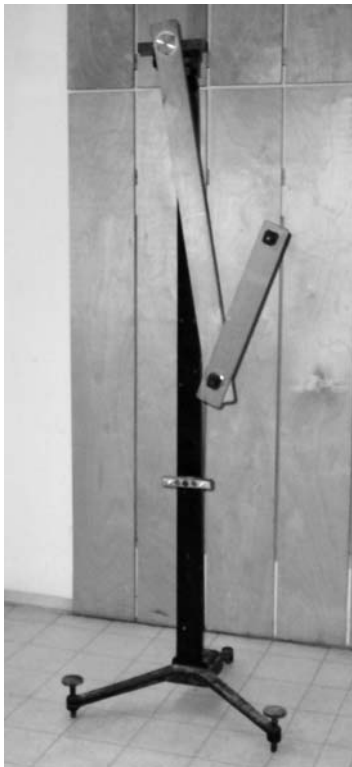
7. ábra: A mérésen használt kettős inga
