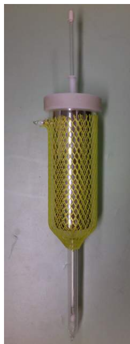
3.3. ábra. A méréshez használt kriosztát.
