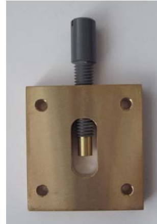
4.10. ábra. Vázlatos kép az új és a régi csatolóelemről, és fotó az elkészült új csatolóelemről
