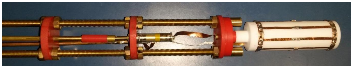
8. ábra: Mérőfej a proton birdcage tekercssel [2]
