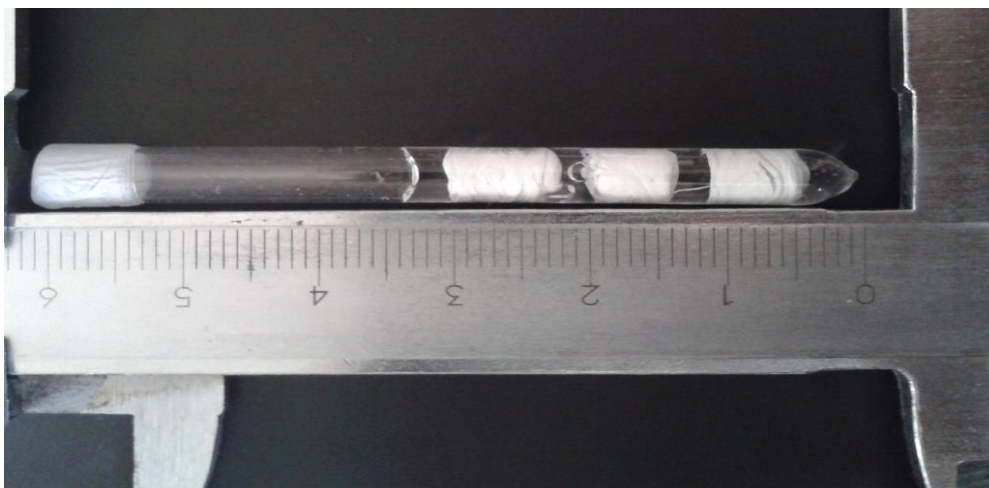
14. ábra: Bonyolultabb fantom egy- és kétdimenziós mérésekhez
