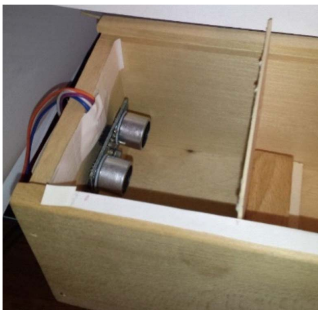
4. ábra. Mérődoboz a könnyebb, reprodukálhatóbb mérésekhez.
