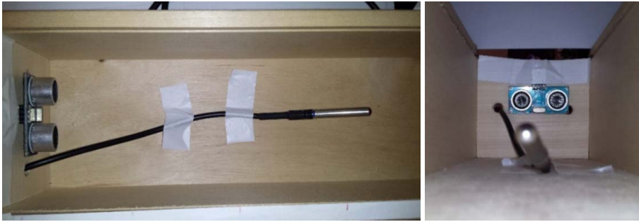
6. ábra. A hőmérséklet-érzékelő elhelyezése.
