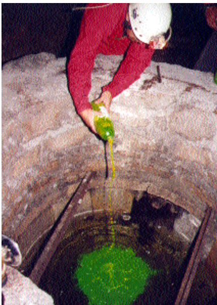
12. kép. Vízfestéses vizsgálat az áramlási viszonyok megállapítására
