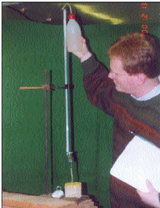
9. kép. Vízáteresztőképességi együttható meghatározása Édesvízi Mészkő mintán
